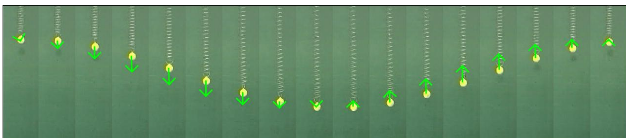
Abbildung 136: Streifenbild eines Schwingungsvorgangs beim Federpendel
