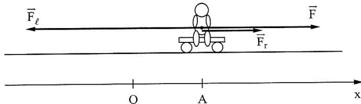
Beachten Sie, dass die Federn um je 60 cm vorgedehnt sind. Die rechte Feder wird deshalb durch die Auslenkung des Sitzes nach rechts um die Strecke 46 cm nicht gestaucht, sondern nur entspannt; die zugehörige Federkraft  $\vec{F}_r$  zeigt nach rechts.
