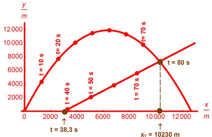
Die Punkte auf den Kurven geben Zeitpunkte (in s) an, zu denen sich die Rakete bzw. die Drohne an den betreffenden Ortspunkten befindet.
